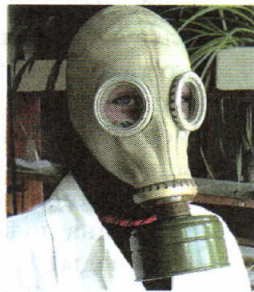
Рис. 86. На свойстве активированного угля поглощать вредные газы основано действие фильтрующего противогаса
