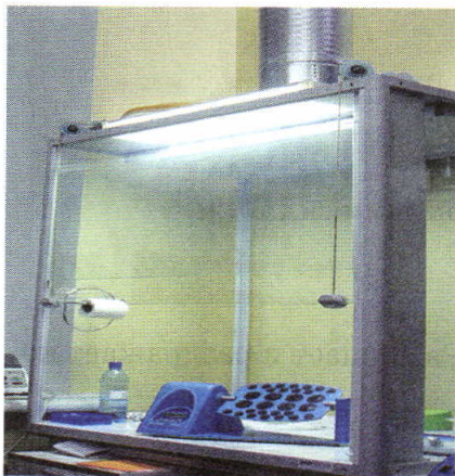
Рис. 27. Вытяжной шкаф в школьной лаборатории
