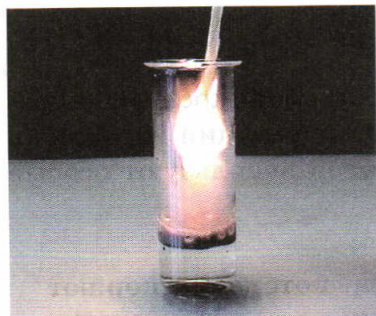
Рис. 99. При разложении H_2O_2 выделяется кислород, что можно доказать с помощью тлеющей лучинки
