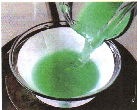
Рис. 83. Фильтрование жидкости с осадком через бумажный фильтр
