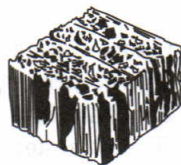
Рис. 85. Адсорбент — активированный уголь под микроскопом
