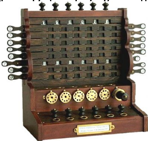
Суммирующая машина Шиккарда (реконструкция по рисунку) 1623 год
