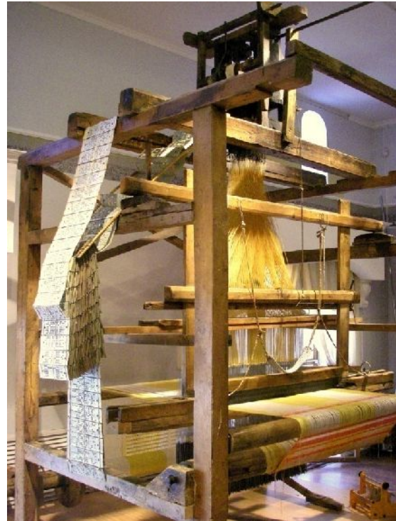
Перфокарты задают узор ткани для ткацкого станка
