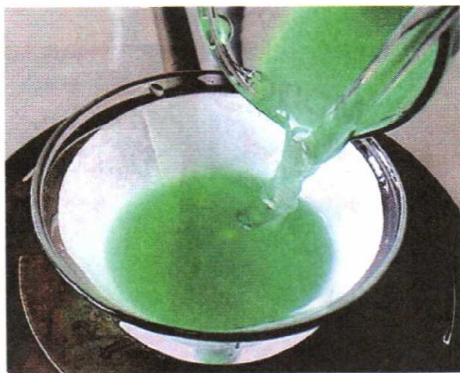
Рис. 83. Фильтрование жидкости с осадком через бумажный фильтр
