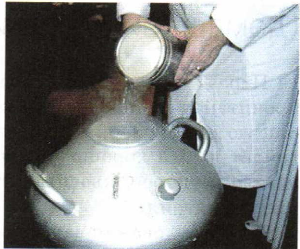
Рис. 91. Сжиженный азот хранят в специальных термосах
