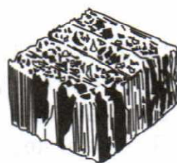
Рис. 85. Адсорбент — активированный уголь под микроскопом
