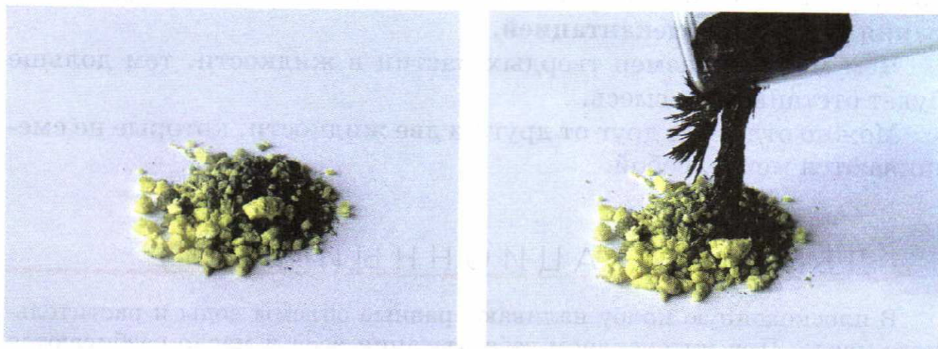
Рис. 79. Разделение железных опилок от порошка серы с помощью магнита
