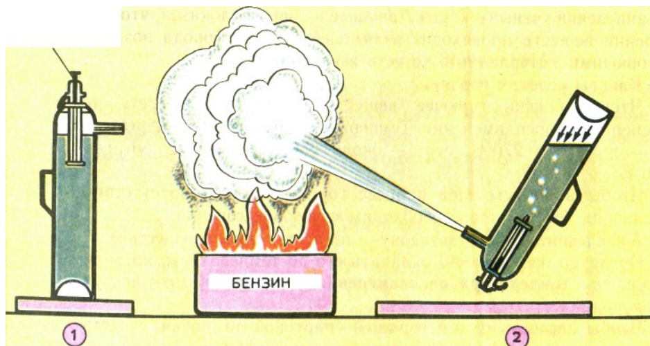
Рис. 10. Огнетушитель: 1 —устройство (в разрезе); 2 — тушение горящего бензина
