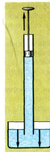
Рис. 40. Подъем воды за поршнем
