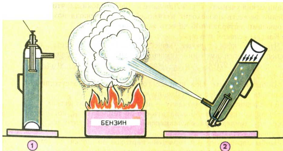
Рис. 10. Огнетушитель: 1 —устройство (в разрезе); 2 — тушение горящего бензина
